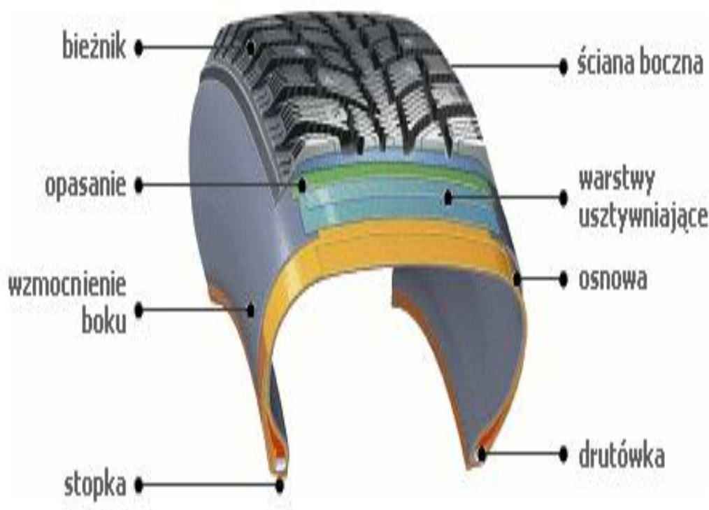
Rys. 3.1. Budowa opony[8]
