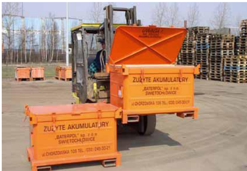
Rys.1.2 Pojemniki do bezpiecznego gromadzenia i transportu złomu akumulatorów [Źródło: www.baterpol.pl ]
